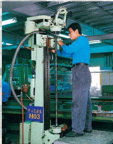
▲ CENTER HOLE GRINDER (SWISS)
