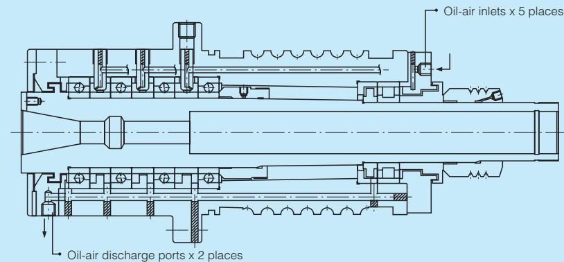
Fig. 4.9 Oil-Air Lubrication
